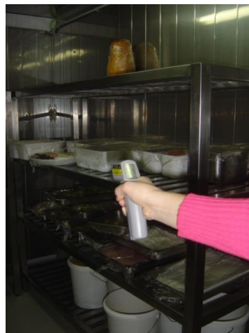
Εικόνα 30:Θερμομέτρηση ψυκτικού θαλάμου
